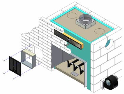
FIGURE 8B: AIR INTAKE GRILLE INSTALLATION
